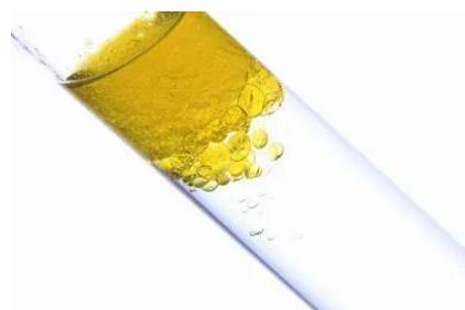
Essa simples mistura é suficiente para visualizarmos diversas propriedades da matéria, como a solubilidade (por não se dissolverem) e a densidade (por se posicionarem de forma diferente).
