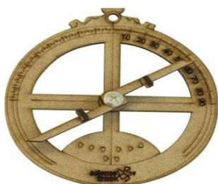
**Astrolábio:** Para utilizar o **astrolábio**, o observador aponta a régua central para o astro utilizado como referência e em seguida observa as graduações do instrumento. A partir dessa observação e com base nos conhecimentos de astronomia, os navegadores poderiam precisar sua localização em alto mar e fazer o cálculo das rotas.
