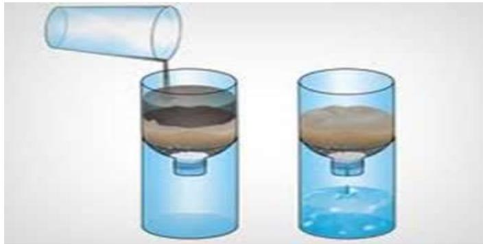
LEMBRE- SE QUE ESTE FILTRO CASEIRO É SÓ UMA DEMOSTRAÇÃO DE COMO FUNCIONA O PROCESSO DE FILTRO DE IMPUREZA DA ÁGUA E NÃO PODEMOS BEBER DIRETAMENTE A ÁGUA FILTRADA . ELA AINDA PRECISA PASSAR POR OUTROS PROCEDIMENTOS COMO FERVER E ADICIONAR SUBSTÂNCIA COMO CLORO E FLÚOR
