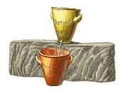
O RELÓGIO DE ÁGUA BASEAVA-SE NA COLOCAÇÃO DE 2 RECIPIENTES EM POSIÇÕES DIFERENTES. UM DELES CHEIOS DE ÁGUA ERA COLOCADO SOBRE O OUTRO, FUNDO E VAZIO. EM SEGUIDA, ERA FEITO UM FURO NO RECIPIENTE SUPERIOR (DE CIMA), QUE GRADUALMENTE TRANSFERIA A ÁGUA PARA O RECIPIENTE INFERIOR ( DE BAIXO).
